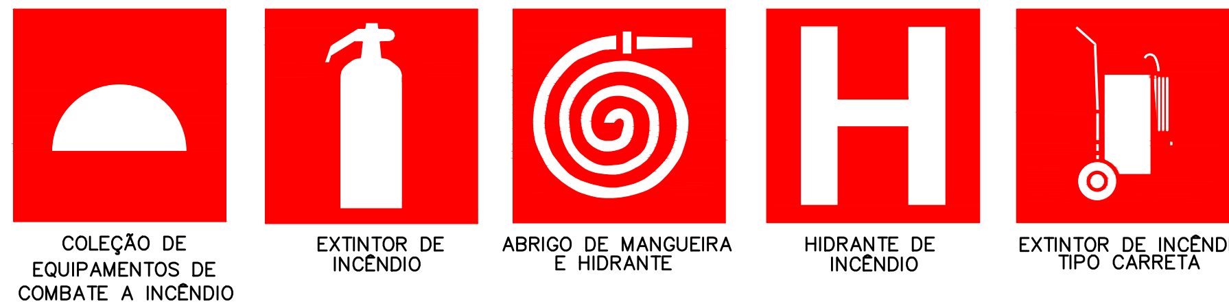
DETALHE A1 - SINALIZAÇÃO DE EQUIPAMENTOS DE COMBATE A INCÊNDIO E ALARME
